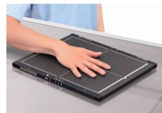
「AeroDR1012HQ」は、他の「AeroDR」シリーズと同様に、ヨウ化セシウム(CsI)シンチレータ(蛍光体)<sup>※4</sup>の採用により、CR<sup>※2</sup>に比べ約半分のX線照射量でも高画質の診断画像を得ることができます。さらに、環境・エネルギー分野を中心に次世代バッテリーとして注目されているリチウムイオンキャパシタ<sup>※5</sup>を採用。安全性が高く発火の危険性が無い、充電速度が速い、充放電を繰り返しても劣化しにくいという特長に加え、環境に配慮した省電力設計も兼ね備えています。
