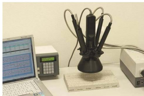
さまざまな産業分野、中でも製造業における品質管理において、計測装置による色彩管理はたいへん重要な要素となっており、生産工程にインライン測色システムを導入して全数チェックをしているメーカーも少なくありません。しかしながら、建物の外壁材やパンの焼き色など、凹凸のある物体では反射光が一定でないために、従来のインライン測色システムで正確に測定することができませんでした。コニカミノルタは、この問題を解決した「高速非接触インライン測色システム」を開発しました。
