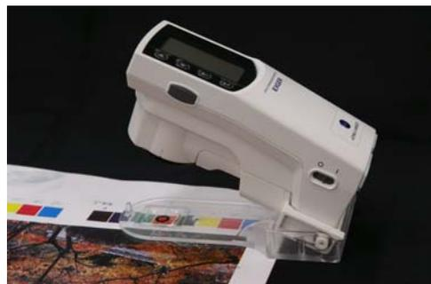
また、PC ソフトを使用することで、オフセット印刷の国際規格 ISO12647-2 適合性評価を容易に行うことも可能です。
