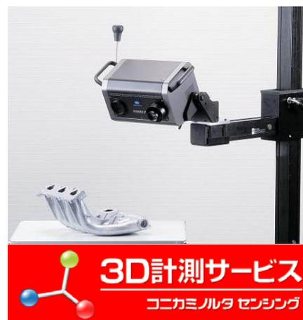
近年、自動車メーカー・家電メーカーなどの各種部品や金型の開発・製造の場において、物体の3次元形状を非接触で瞬時に測定できる非接触3次元デジタルの活用が急速に広がっています。
