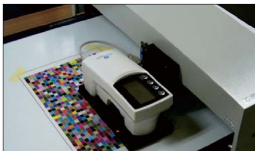
図) FD-5 + XY ステージによるチャート自動測定
