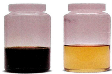
図4 劣化した作動油の外観(左)と新油の外観(右)の比較 (提供：コベルコ建機)
