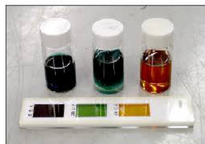
図5 劣化に伴う絶縁油の変色の例 (提供：四国電気保安協会)
