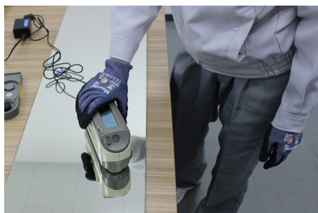
図8 分光測色計によるDLCコート浴室鏡の色差測定（膜厚測定）の様子
