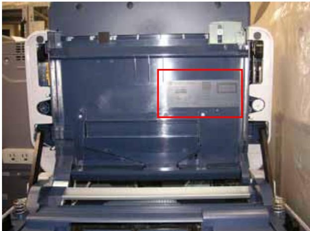
3) シールの左側、バーコード上部の 10 桁の数字がプリンタ本体の製造番号になります。
