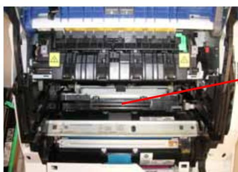
ドラムカートリッジを取り外し、底面部分の手前よりにレーザーレンズがあります。乾いた布で表面の汚れを拭き取ります。
