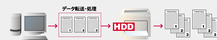
1.まず一部目を印刷 2.同時にデータをメモリ・HDDに蓄積 3.ラスタライズされたデータを活用して2部目以降を印刷
