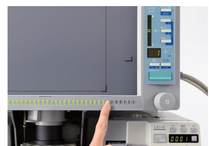
使いやすさ、見やすさに配慮し、プリントスタートボタンをはじめ各種操作ボタンと表示ランプをスクリーンの横にまとめてレイアウト。画面を見ながら作業でき、効率が大幅にアップします。
