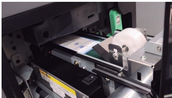
Justfit サービスにより、TU-510e に自動排紙のベルトコンベアを装着。機械内で断裁された名刺が、1,000 枚（10 ジョブ）まで自動で排出できる
