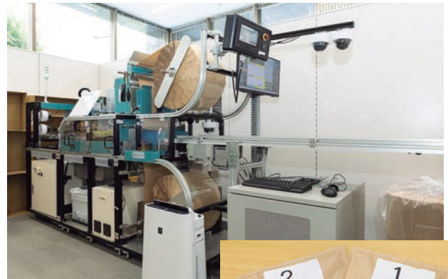
株式会社シブソルの自動梱包機「メルパックライン」。名刺を自動包装し、送り状まで貼付してくれる。この梱包機はコニカミノルタを通しての導入も可能
