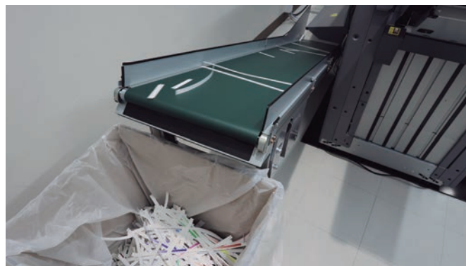
加工時に排出される切りくずは、もう1つのベルトコンベアでゴミ箱まで自動運搬。ゴミ捨ての回数や負担も軽減した
