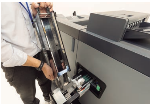
名刺を 1 回の印刷で 1,000 枚まで、専用のトレイに排紙できる。業務効率化に大きく寄与している
