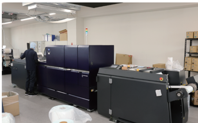
昨夏導入したコニカミノルタのデジタルラベル印刷機「AccurioLabel 400」。ポリウムゾーンである2～5万枚の案件もこなしている。
