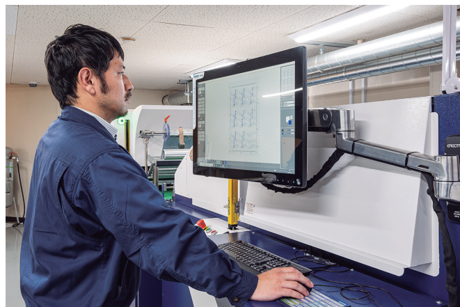
タッチスクリーンから、見当位置合わせやニスの高さ調整など、熟練技術が必要な工程もデジタルで容易に行うことができる
