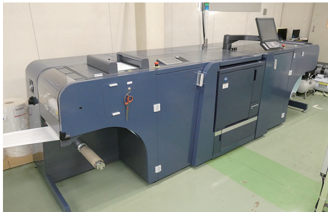
コニカミノルタ製デジタル印刷機「AccurioLabel 230」。多品種小ロットのラベルを製造
