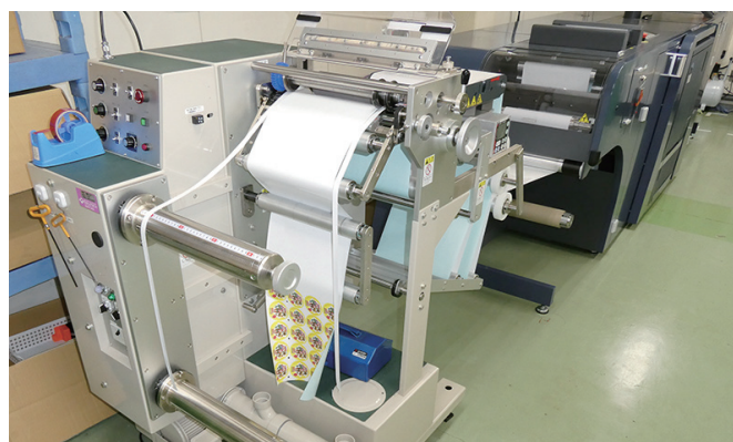
スリッターを連結し、幅の異なる多面付ラベルを加工
