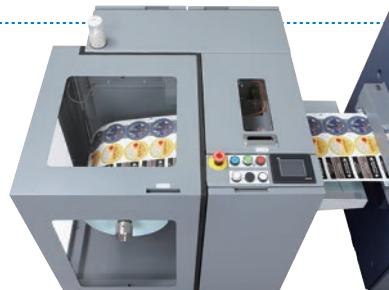
例)A4サイズに8枚のラベルを面付けした場合→10,000枚(263m)を約25分(13.5m/分)で印刷可能
