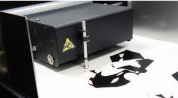
エアサクション用紙搬送により、メディアへのダメージを最小化
