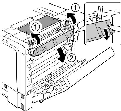
11 保護材 (2箇所) を取り外し、定着力バーを閉じます。
