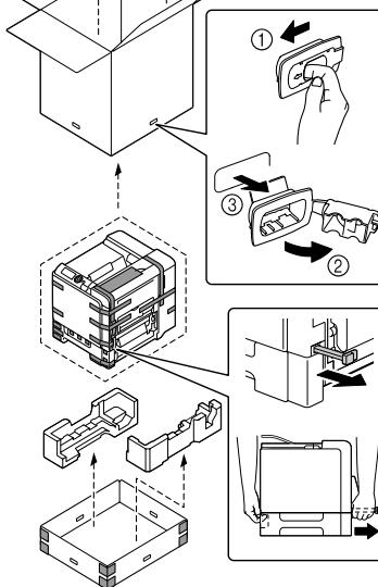
4 プリンタの外装部を固定している保護テープをすべて取り外します。
