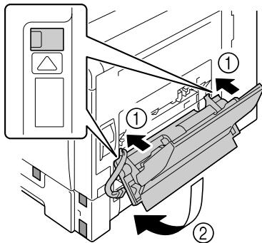
16 固定レバー（2箇所）を下ろし、手差しトレイをプリンタに固定します。
