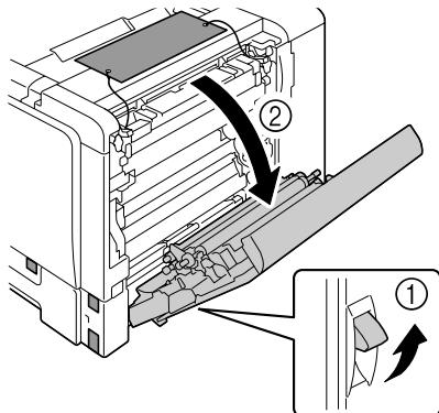
10 定着力バーのレバー (2箇所) を押し上げ (①)、定着力バーを開きます (②)。
