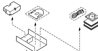
図の要領で止め具（4箇所）を外し、梱包箱を上へ引き上げて取り外します。
