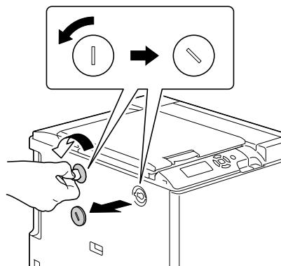
**23** ステープルフィニッシャー取り付け用フックを、プリンタ左側面に取り付けます。
