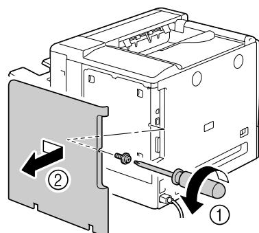
**3** ドライバを使ってネジ7個をゆるめます。(ネジは取り外さないでください。)
