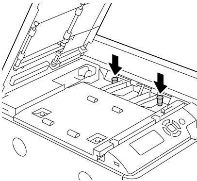
**13** 中継ユニットを固定用フックでプリンタ上部に固定します。
