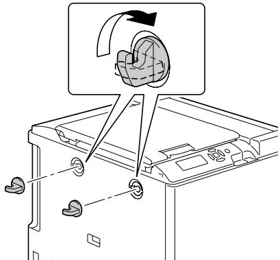
**24** 中継ユニットの側面とステープルフィニッシャーの側面を合わせ、ステープルフィニッシャーをフックに引っ掛けて取り付けます。
