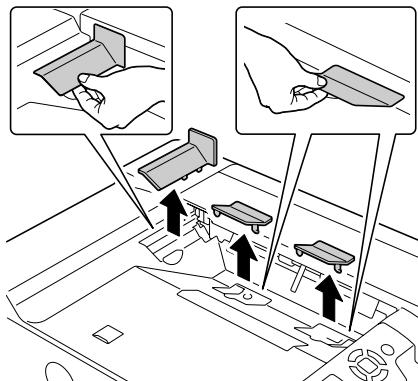
**9** プリンタ上部の手前のカバー（2箇所）をコインで取り外します。
