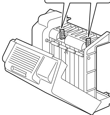
**4** 図のように、両面プリントユニットの爪を本体の取り付け用孔に差し込んで、両面プリントユニットを取り付けます。
