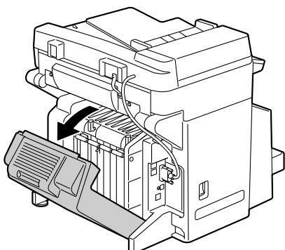
**6** 両面プリントユニットを本体に押しつけて、2箇所のノブを水平の位置まで回し、両面プリントユニットを本体に固定します。
