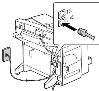
電話機を本機に接続して使用する場合、電話機は本機左側面の外付け電話機接続用コネクタ（TEL）に接続します。
