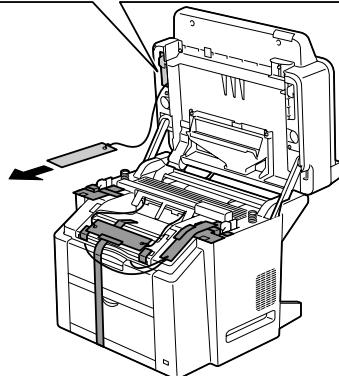
**9** 正面の保護材を取り外し、右側の保護材を移動します。
