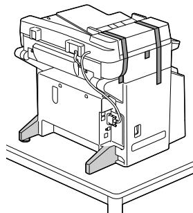
**4** 本機の外装部を固定している保護テープをすべて取り外します。
