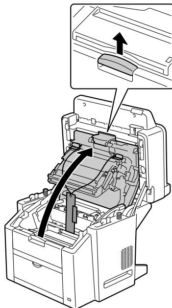
**12** 左右の定着ユニット解除レバーが浮き上がった状態（封筒モード）になっていないことを確認します。
