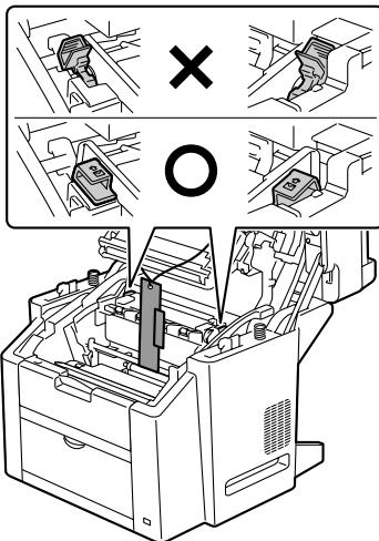
**13** 離間材を固定している保護テープを取り外します。
