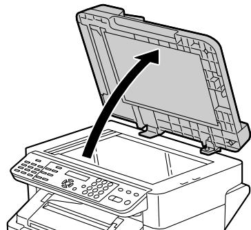
**4** 送信する面を下にして原稿を原稿ガラス上に置き、原稿スケールに沿うように合わせます。
