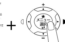
登録をキャンセルするには、キャンセル/C キーを押します。(名称を入力している途中で登録をキャンセルする場合は、メニュー選択キーを押してからキャンセル/C キーを押します。)
