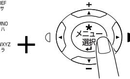
登録をキャンセルするには、キャンセル/Cキーを押します。(名称を入力している途中で登録をキャンセルする場合は、メニュー選択キーを押してからキャンセル/Cキーを押します。)
