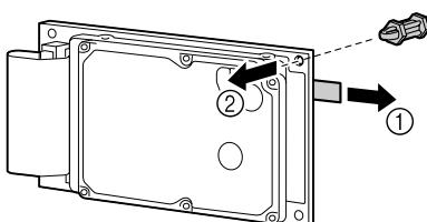
6 ハードディスクをプリンタのコントローラボードに取り付けます。
