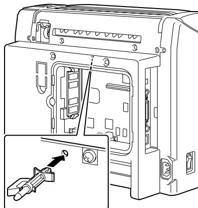
5 電池とハードディスクの間の絶縁スペーサーを取り外し、ハードディスクのコントローラボードに、スペーサーを取り付けます。
