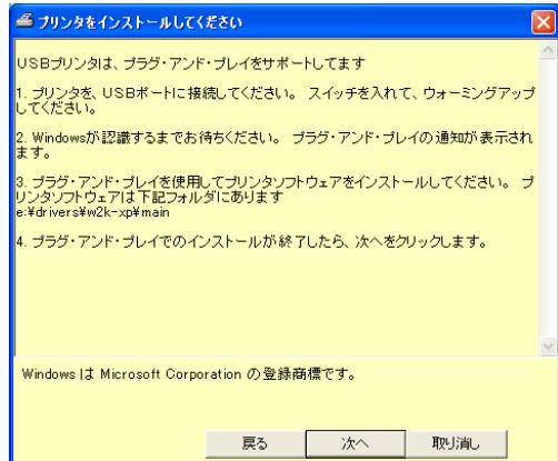
**4** プリンタとコンピュータを接続します。USB ケーブルの一方をコンピュータの USB ポートに、もう一方をプリンタの USB ポートに接続します。
