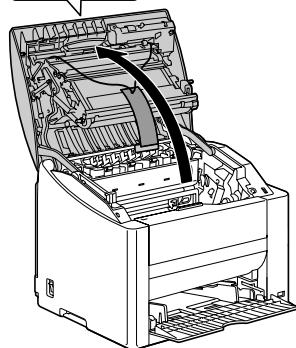
**9** 左右の定着離間レバーが起き上がった状態（封筒印刷位置）になっていないことを確認します。
