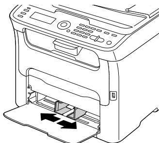
17 印刷したい面を上向きにして用紙をセットします。
