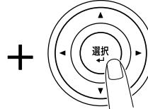
10 [▼] / [▲] キーで、目的のモデムスピードを選択し、[選択] キーを押します。モデムスピードが設定されます。手順 11 へ進みます。
