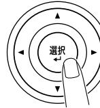
[▼] / [▲] キーで、削除したい相手先を選択し、[ストップ/リセット] キーを押します。
