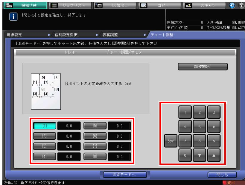
**10** 入力が完了したら、[調整開始] を押します。
