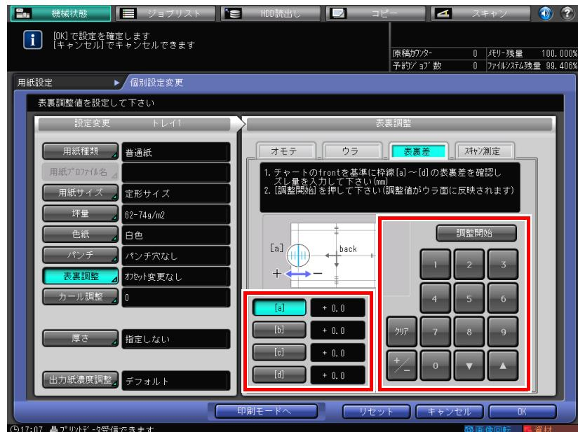
**9** 入力が完了したら、[調整開始] を押します。
