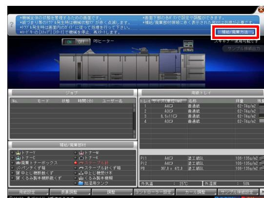
**3 該当する中とじ機の【中とじ針補給】タブを押してから、画面の表示に従って、ステープル針を交換します。**
