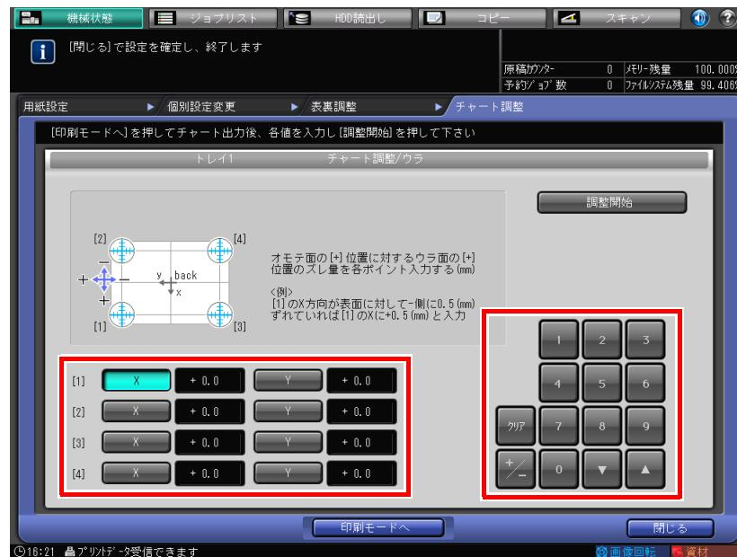
**17** 入力が完了したら、[調整開始] を押します。
