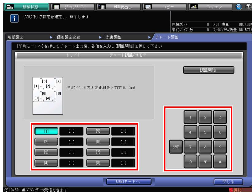
**10** 入力が完了したら、[調整開始] を押します。
