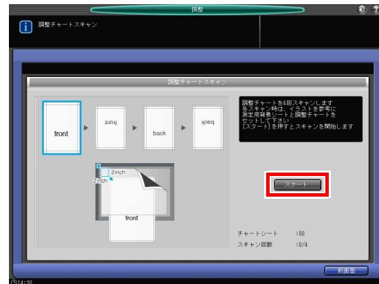
スキャンが正しく終わると、調整チャートスキャン画面の [スキャン回数] の表示が 1 つ線上がり、画面上部のイラストにある青枠表示が、1 つ右のイラストに移動します。
