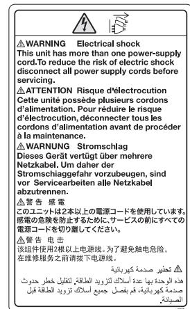
**2.3.15 インテリジェントクオリティオプティマイザー IQ-601、紙面検査ユニット AI-101、ペーパーフィーダーユニット PF-712、ペーパーフィーダーユニット PF-713、ペーパーフィーダーユニット PF-812、中綴じ機 SD-506、中綴じ機 SD-513、中継搬送ユニット RU-518m、中継搬送ユニット RU-702、折り機 FD-503、イメージコントローラー IC-614、大容量スタッカー LS-507、トリマーユニット TU-510、インテリジェントメディアセンサー IM-104 のアース（接地）警告ラベル**
