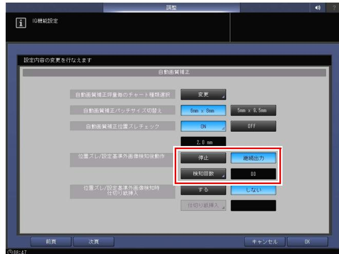
異常を何回検知しても、印刷は継続されます。
