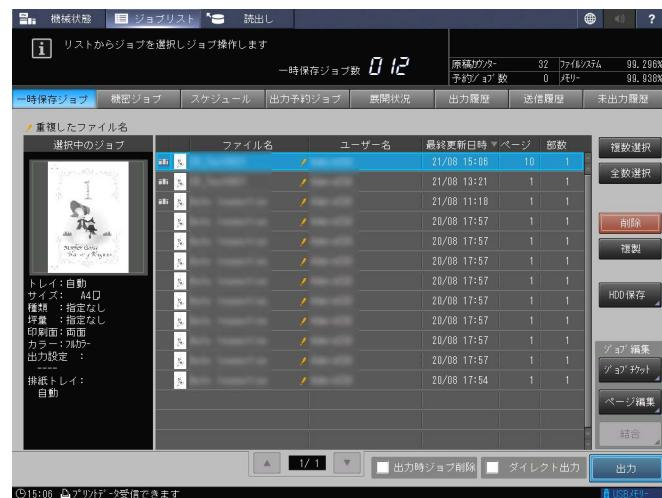
10 [出力] を押し、[出力方法] から [通常] を選択して、[OK] を押します。
