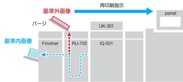
ここでは、異常が検知された印刷物と機内の用紙を中継搬送ユニット RU-702 のページトレイに排出して、再印刷を行う機体構成を例とします。
