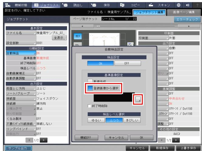
7 使用する [基準画像] を選択し、[OK] を押します。
