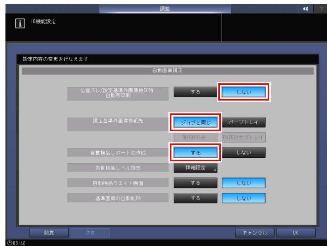
[位置ズレ / 設定基準外画像検知時自動再印刷] : [しない]
