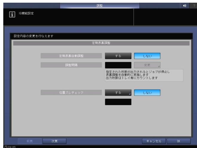
2 [位置ズレ / 設定基準外画像検知後動作] の [継続出力] を選択し、[検知回数] を画面のテンキーで「00」と入力します。
