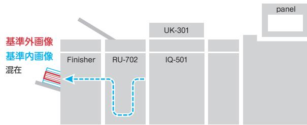
この例では、通常の印刷物と異常が検知された印刷物が同じトレイに混在します。自動検品レポートを確認して、手動で対処してください。
