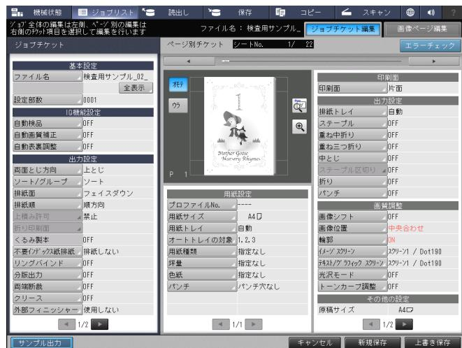
6 [自動検品] を押し、[検品設定] を [ON] に設定して [基準画像設定] の [新規作成] を有効にします。
