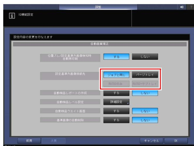
4 [位置ズレ / 設定基準外画像検知時自動再印刷] の [しない] を選択します。
