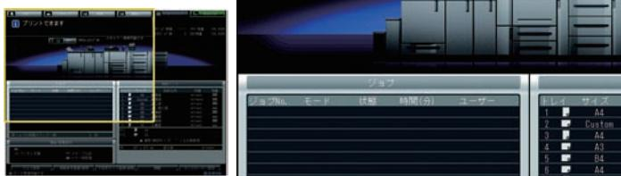
くるみ製本機ヒーターがウォームアップの状態のとき、機械状態画面にウォームアップ状態を表示します。
