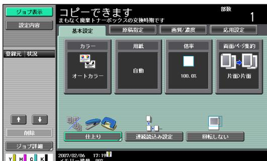
廃棄トナーボックスの交換時期になると、交換時期メッセージが表示され、本機は停止します。(ユーザー交換の場合)
