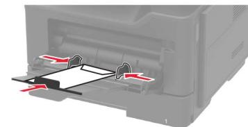
警告-破損の恐れあり: 切手、留め金、スナップ、窓、つや出し加工された内張り、封かん用口糊の付いた封筒は使用しないでください。
