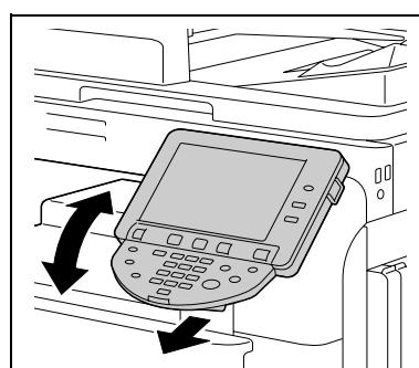
→ 操作パネルを傾ける場合は、操作パネル下部を持って左右位置を調整します。
