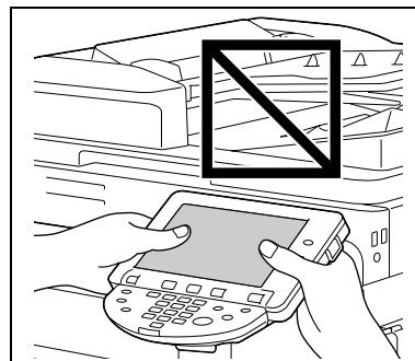
→ 操作パネル解除レバーを手前に引き、ゆっくりと操作パネルを上下させます。
