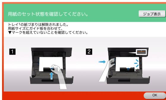
用紙を戻し、[OK] をタップすると、印刷を再開します。
