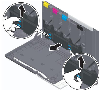
**3 プリントヘッド窓清掃具を、本機の前ドアから取外します。**
