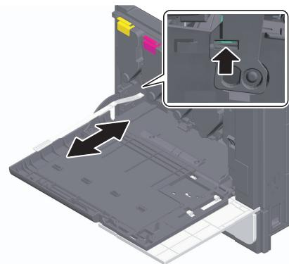
**5 プリントヘッド窓清掃具を、本機の前ドアに取付けます。**
