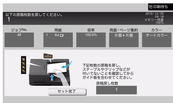
原稿または用紙を戻し、[OK] または [セット完了] をタップすると、原稿の読み込みまたは印刷を再開します。
