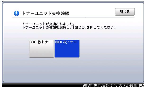
ご使用されているトナーユニットの種類が機器に登録されています。上記画面で選択したトナーユニットが、登録されているトナーユニットの種類と違う場合は、以下の確認画面が表示されます。選択したトナーユニットで間違いなければ、[はい]を押します。選択したトナーユニットの種類が機器に登録されます。
