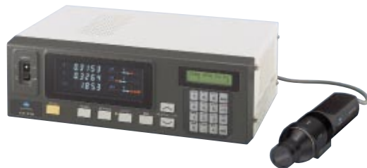
ディスプレイカラーアナライザー「CA-310」 ディスプレイのホワイトバランス調整を行う計測機器として、前機種と合わせて80%以上のシェアを誇っています。
